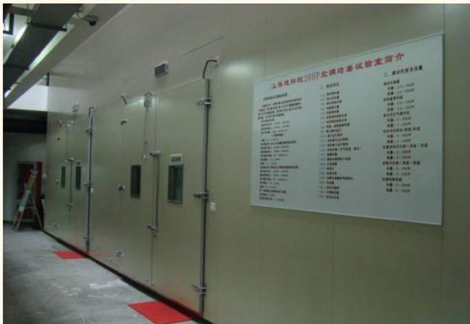
空气源热泵、风机盘管等综合检测装置
